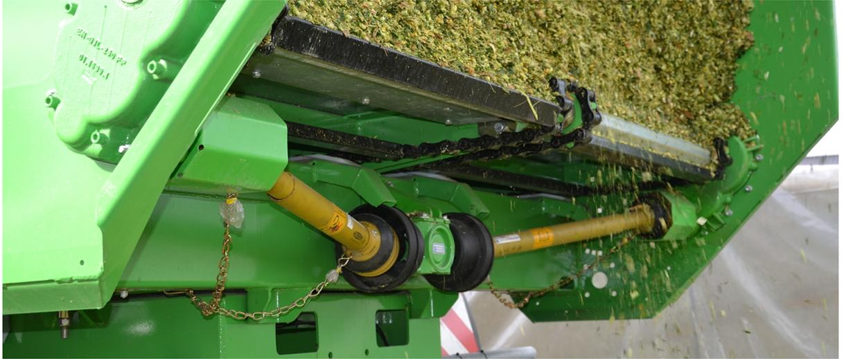
De ahora en adelante es posible equipar las cajas de ensilaje Silo-SPACE con un accionamiento mecánico del suelo, por cardán y caja de transferencia.
